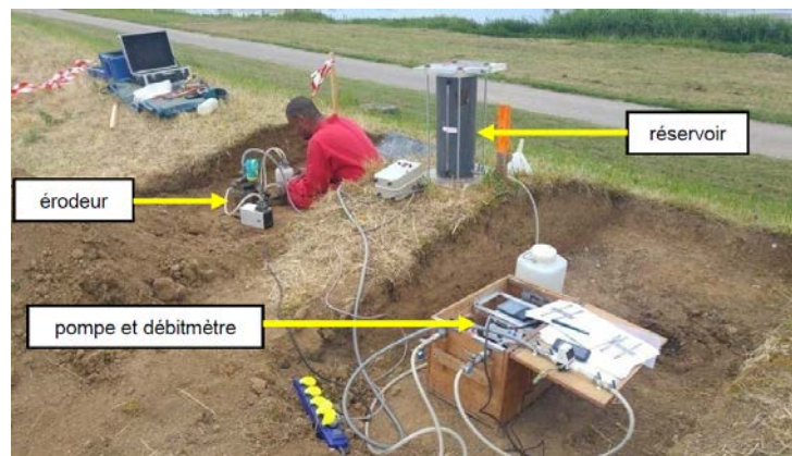
FIGURE 3. Dispositif global de l'essai MoJET.
