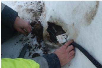
FIGURE 4. Mise en place d’une instrumentation de talus de digue côté val pour l’observation de son comportement vis-à-vis de son environnement (source : Univ. Eiffel/Cerema).
