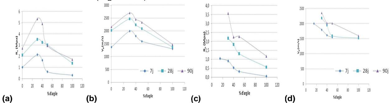
**Figure 6. Evolution de  $R_c$  et  $V_p$  pour la méthode 1 (a et b) et pour la méthode 2 (c et d) en fonction du pourcentage d'argile aux trois temps de cure 7, 28 et 90 jours pour un dosage en ciment de  $140 \text{ kg/m}^3$**
