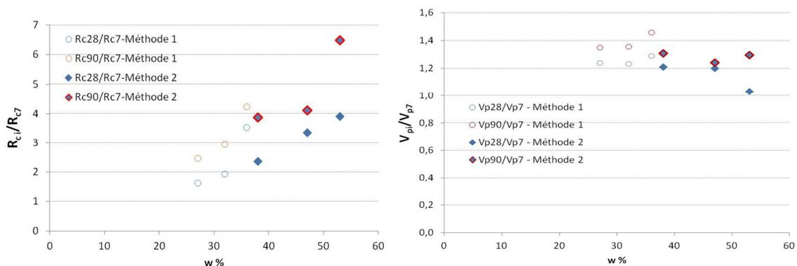
Figure 5. (a) Développement de la  $R_c$  entre 7 et 28 j et entre 28 et 90 j et (b) évolution des vitesses  $V_p$  pour un mélange sable-argile à différents pourcentages d'argile à dosage en ciment constant (soit  $140 \text{ kg/m}^3$ ) en fonction de la teneur en eau de mélange.
