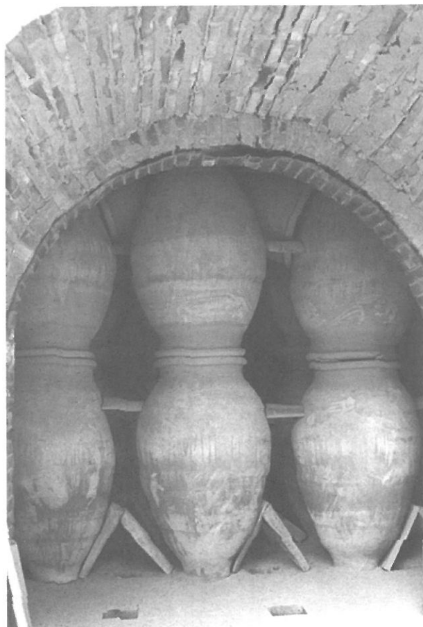
Figure 35 - Empilement de tinajas dans un four de Villarrobledo (région d'Albacete, Espagne) (photographie tirée de Romero, Cabasa 1999, p. 352, fig. 91).
