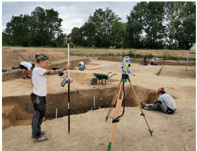
Fig.13 Mise en station de la station libre robotisée Géomax Zoom 90 (cliché E. Hamon)
