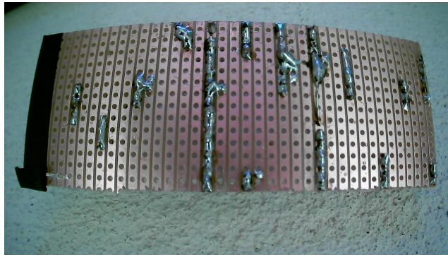
Figure 1.a : Envers du fond de panier
