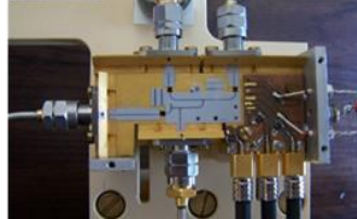
Figure 4. Balise Rx à 60 GHz
