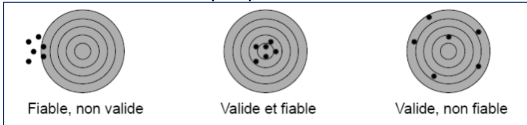
Illustration 3 : Schématisation du principe de la fiabilité et de la validité d'une mesure
