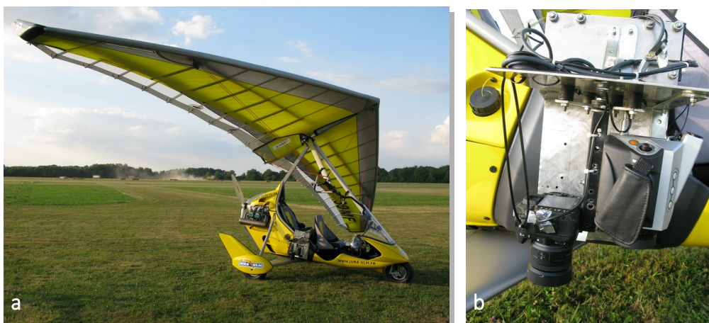
Illustration 1: (a) Vecteur utilisé pour l'acquisition de données (Ultra Léger Motorisé, Jura ULM) avec (b) zoom sur la plate-forme de fixation des capteurs ; APN à gauche, et caméra infrarouge thermique à droite (© B. Marteau).
