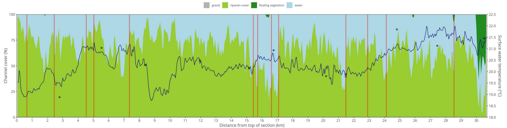
Annexe 4 : Profils de température et proportions de couverture riparienne, de végétation flottante et de bancs de galets sur l' Orain . Les lignes verticales rouges indiquent la présence de seuils. La distance est présentée de l'amont vers l'aval de la section étudiée.
