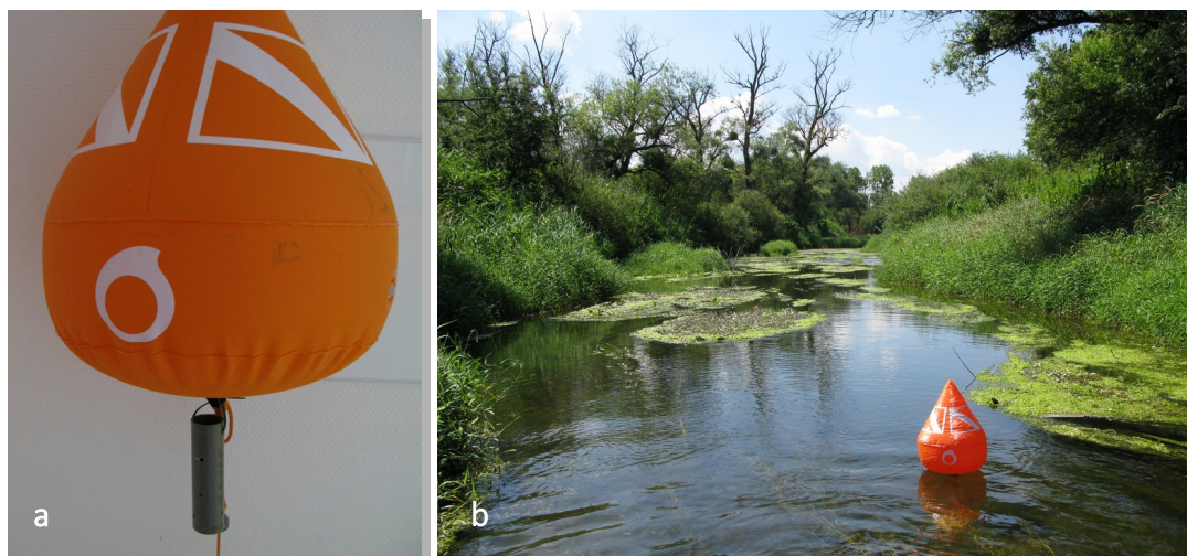
Illustration 2: (a) exemple d'une bouée et de son thermomètre associé, et (b) illustration du déploiement des bouées sur le terrain (ici : l'Orain) (Crédit : Baptiste Marteau, Juillet 2018).
