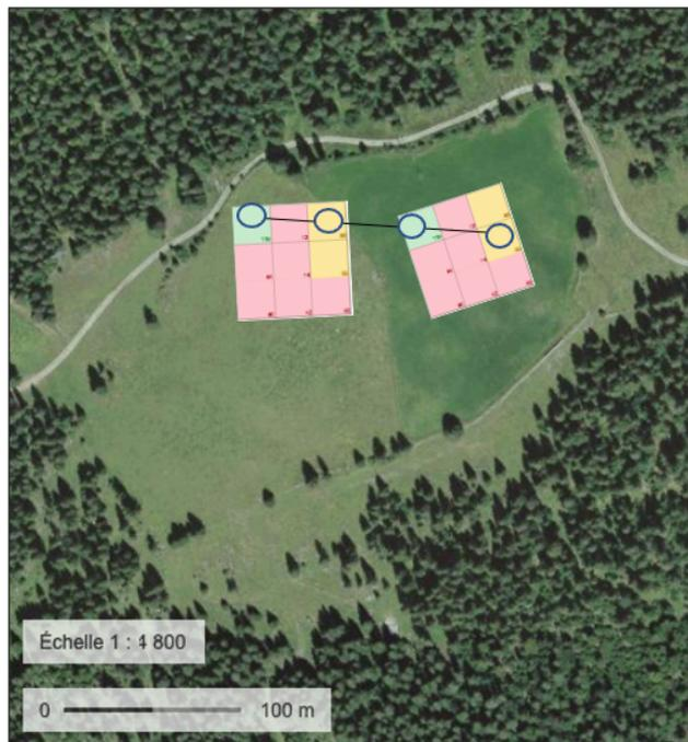
Figure 11. Comparaison de l'échantillonnage par transect de 4 sondages distants de 50 m (cercles) et de l'échantillonnage par grille carrée de 9 sondages distants de 25 m (parcelle OA7 Chaux-Neuve, placettes CD10 et CD9).
