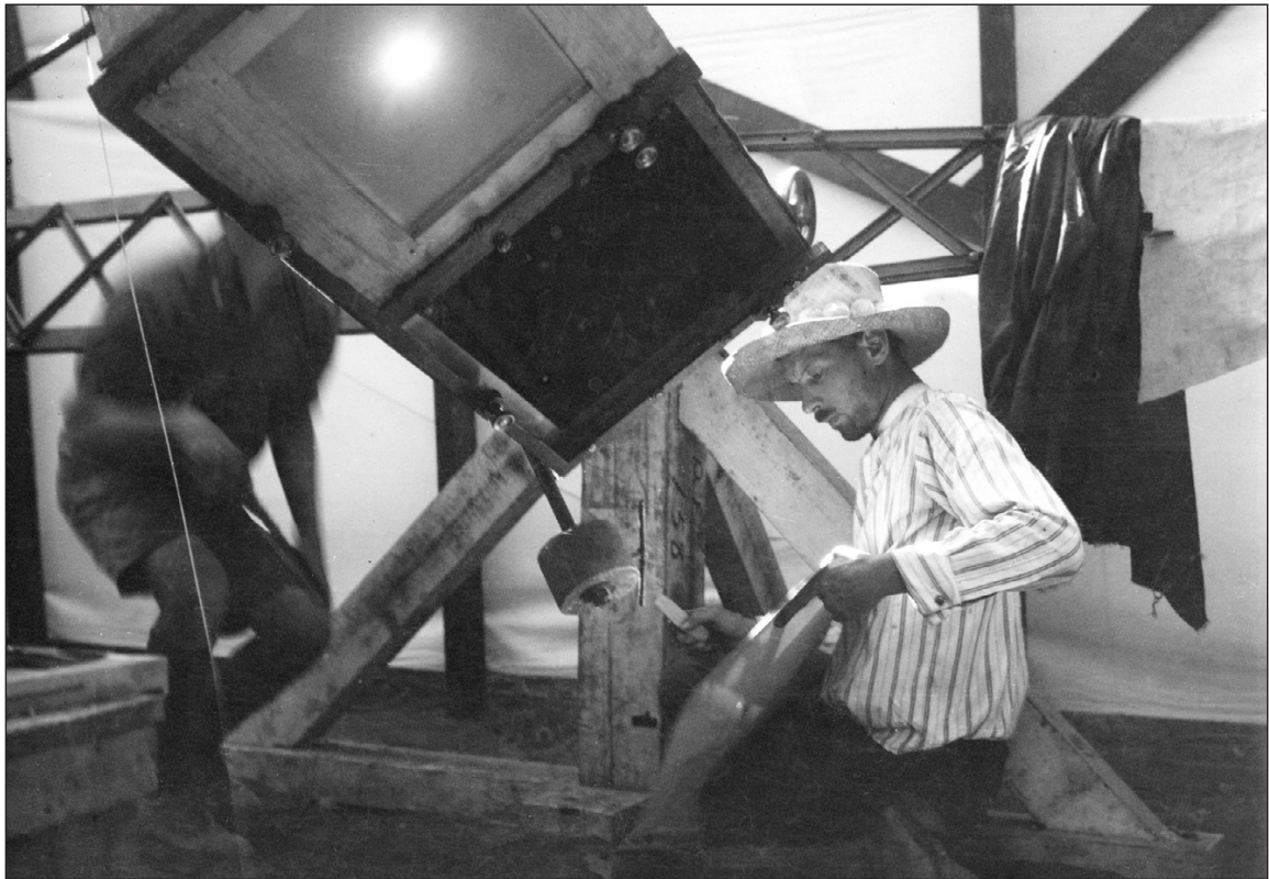
Figure 10 : L'astrographe double de 5 pieds de focale en station à Wallal, après l'acquisition des plaques photographiques de référence à Tahiti. Il fallait en effet, absolument, que l'instrument soit le même, pour éviter toute erreur systématique entre plaques de référence et plaques prises durant l'éclipse. R. Trumpler, de profil en chemise blanche rayée, arbore le même chapeau tahitien qu'en Figure 9.
