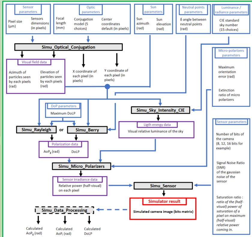
Figure 2 : Structure de l'algorithme de simulation de mesure polarimétrique du ciel. En bleu les entrées, en violet les résultats intermédiaires, en noir les blocs de calculs/fonctions, en rouge le résultat final.
