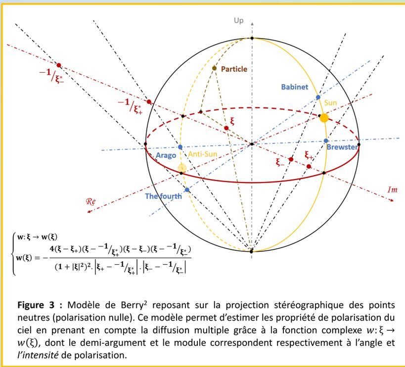
Figure 3 : Modèle de Berry<sup>2</sup> reposant sur la projection stéréographique des points neutres (polarisation nulle). Ce modèle permet d'estimer les propriétés de polarisation du ciel en prenant en compte la diffusion multiple grâce à la fonction complexe  $w: \xi \rightarrow w(\xi)$ , dont le demi-argument et le module correspondent respectivement à l'angle et l'intensité de polarisation.
