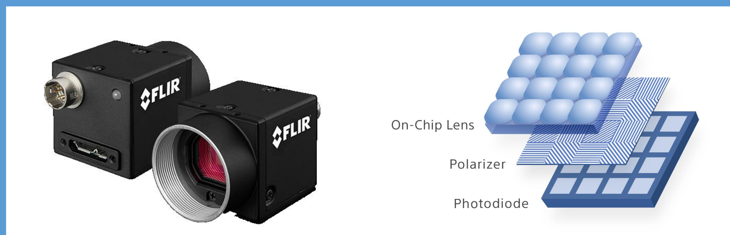
Figure 4 : Type de caméras actuellement simulées. Caméras avec matrice de micro-polariseurs linéaires orientés à 0, 45, 90 et 135 degrés.
