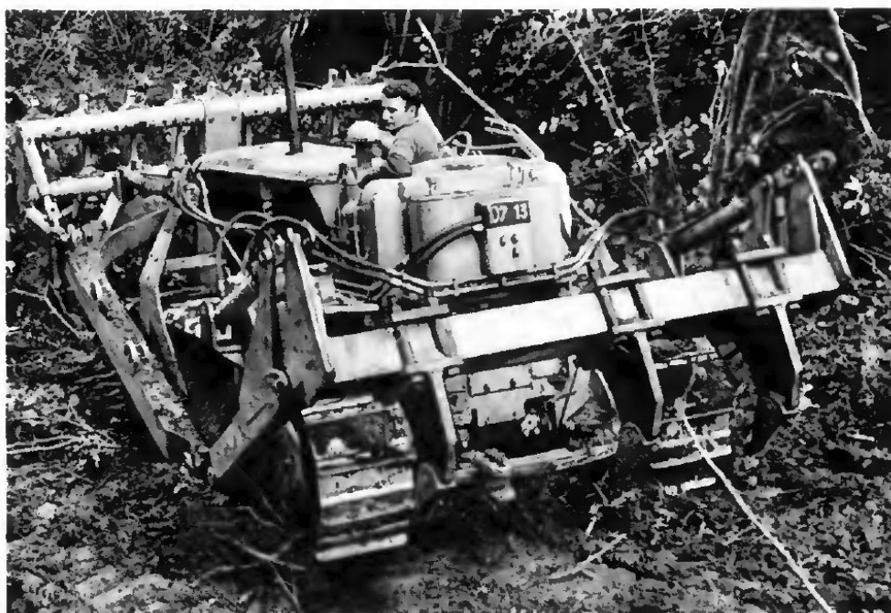
Photo 2 | Tracteur à chenilles équipés d'un rateau débroussaillieur et d'un ripper à trois dents Source : Guiraud, C. (1969). La mécanisation des reboisements. Revue forestière française , 21(S), 421-428.
