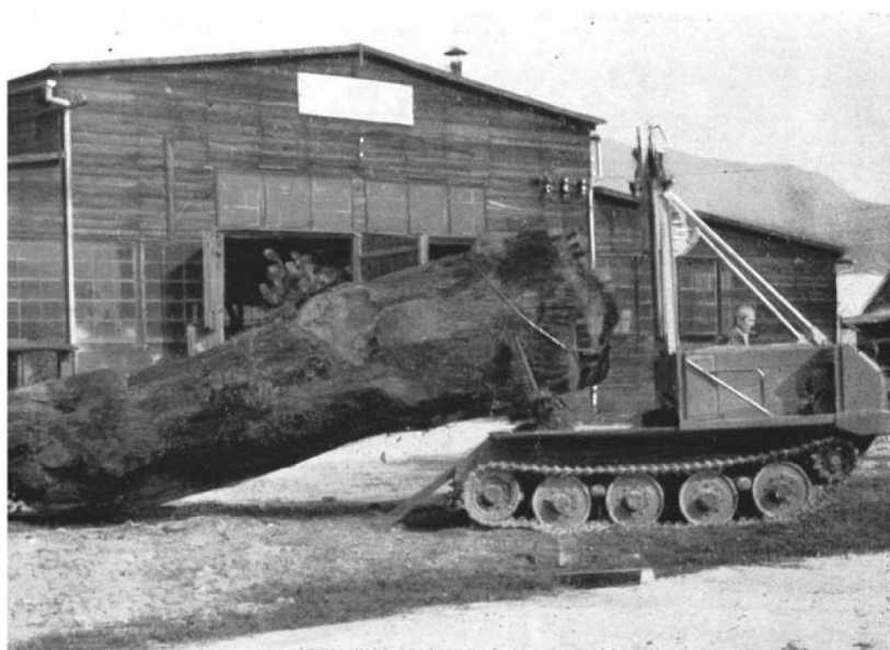
Photo 1 | Tracteur forestier demi porteur à chenilles souples « Motormuli »
