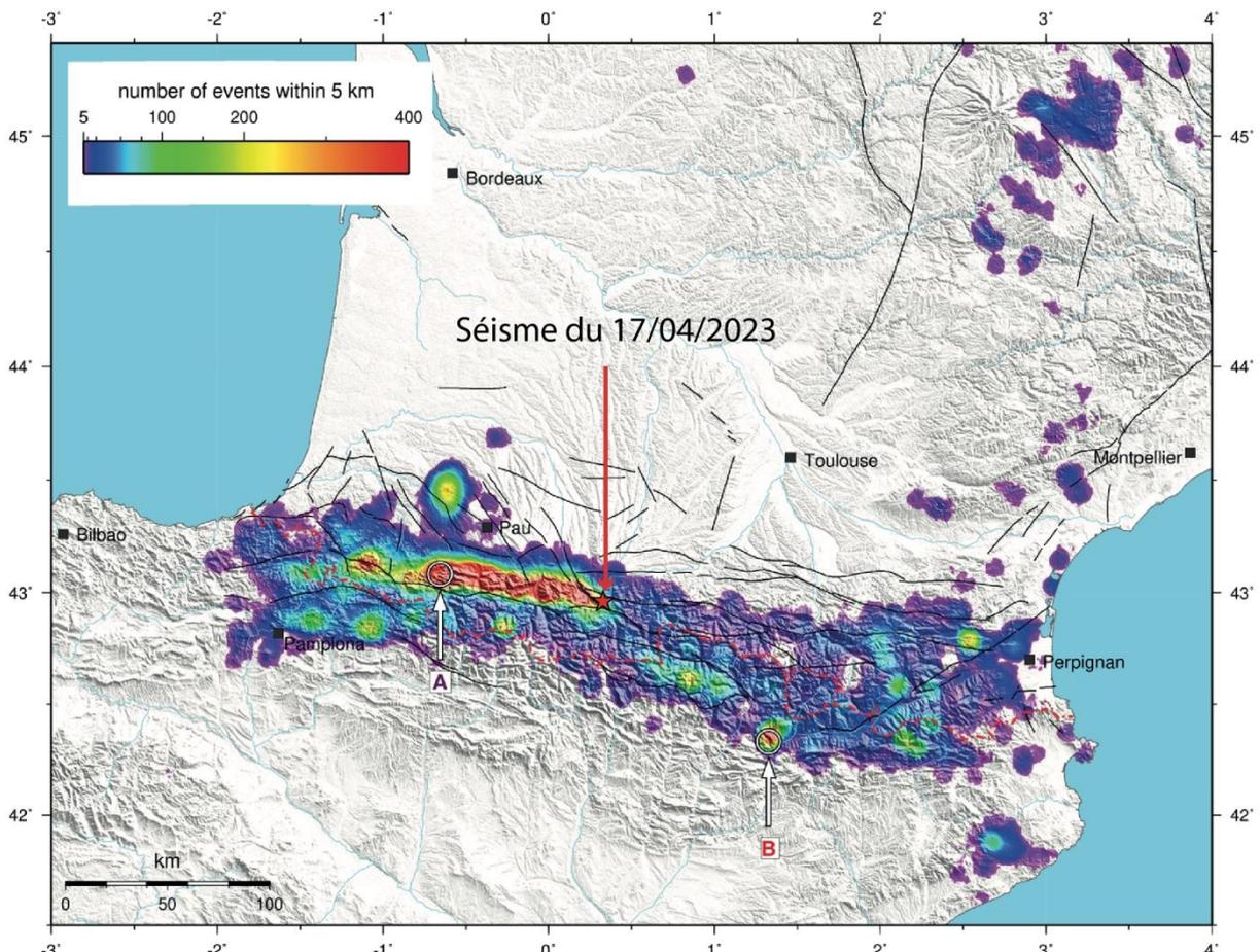
Fig. 1.1 – Carte de densité de sismicité dans le sud-ouest de la France extraite de l'article de M. Sylvander et al. 2021 (C.R. Geoscience, DOI : 10.5802/crgeos.60), A et B désignent les deux régions mises en évidence dans l'article. Les zones rouges indiquent une sismicité active. Les failles actives sont tirées de Lacan et Ortuño [2012].
