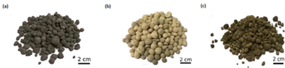
Figure 2. Granulats de REFIOM notés C8 AGG (a), de cendres de papier notés PA (b), de cendres de biomasse notés BAK (c).
