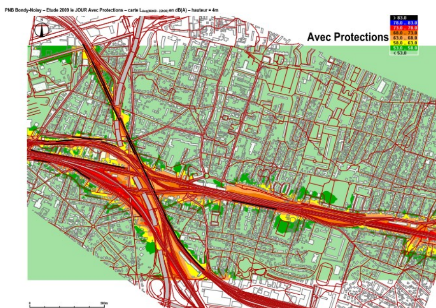
Figure 8: Carte LAeq (6h00-22h00) en dB(A) pour les périodes avant et après la pose des murs antibruit à Noisy-le-Sec et Bondy.
