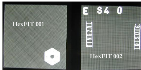
Figure 4. Clichés RX des stratifiés obtenus à partir des HexFIT 001 (renforts orientés à \pm 45^\circ ) et HexFIT 002 (renforts à base de sergé 2x2).
