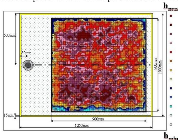
**Figure 7: Cartographie US de l'épaisseur / Thickness Ultrasonic cartography**
