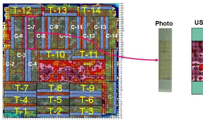
**Figure 10 : Sélection des éprouvettes de traction en fonction de la cartographie US /
