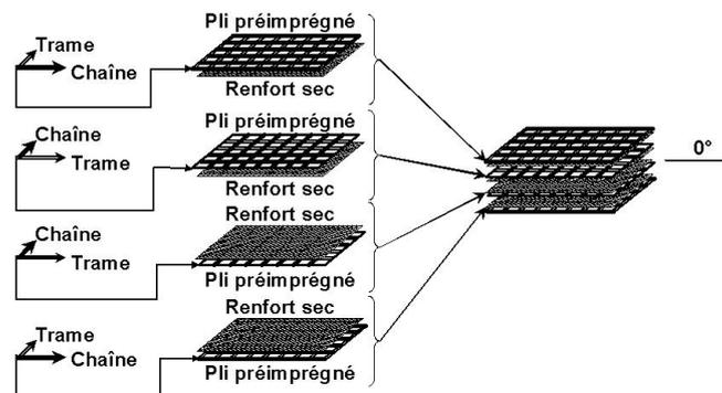
Figure 5: Stratification quasi-isotrope et symétrique / *Symmetric quasi-isotropic lay-up*
