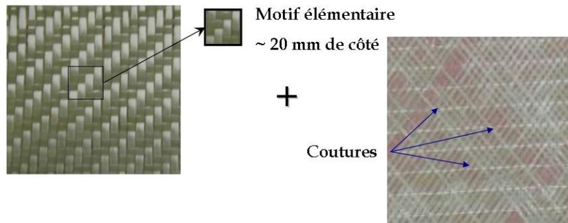
**Figure 6: Structure du pli / Ply structure**
