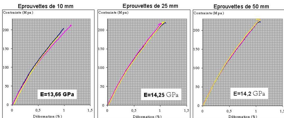
**Figure 11 : Courbes de traction pour des largeurs 10, 25 et 50 mm / Load-extension
