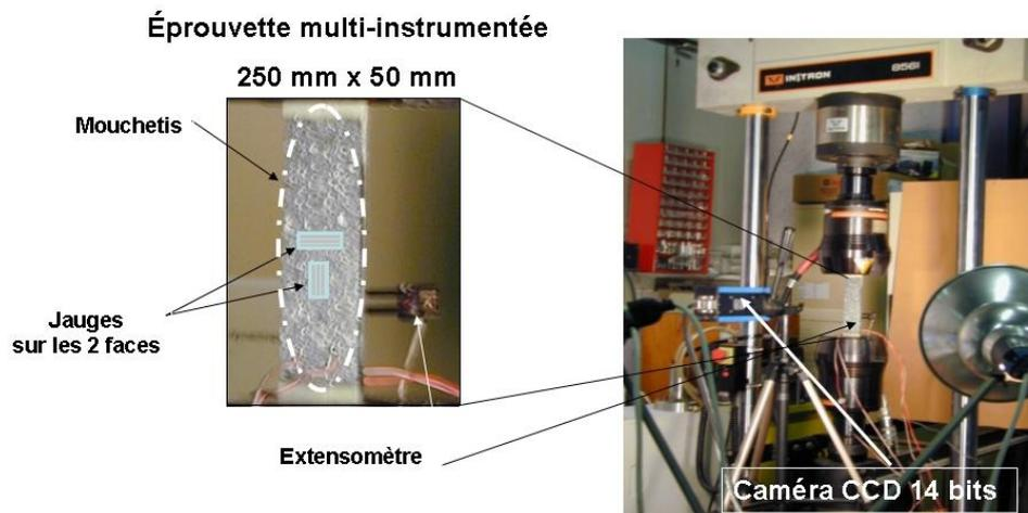
Figure 12 : Eprouvette multi-instrumentée / *Multi-instrumented specimens*
