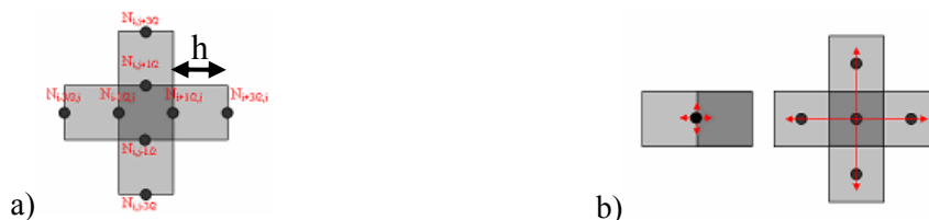
Figure 5. a) Numérotation des nœuds de l'élément K_{i,j} ; b) Ecriture de l'équilibre aux frontières et au centre de l'élément.
