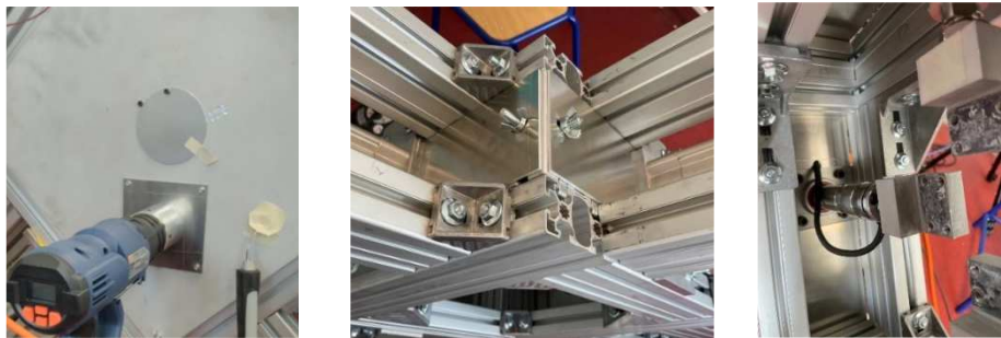
Figure 1 : Conception du système de chauffe (a) pistolet thermique (b) isolation de la zone d'essai (c) système de traction et câbles isolant thermiquement
