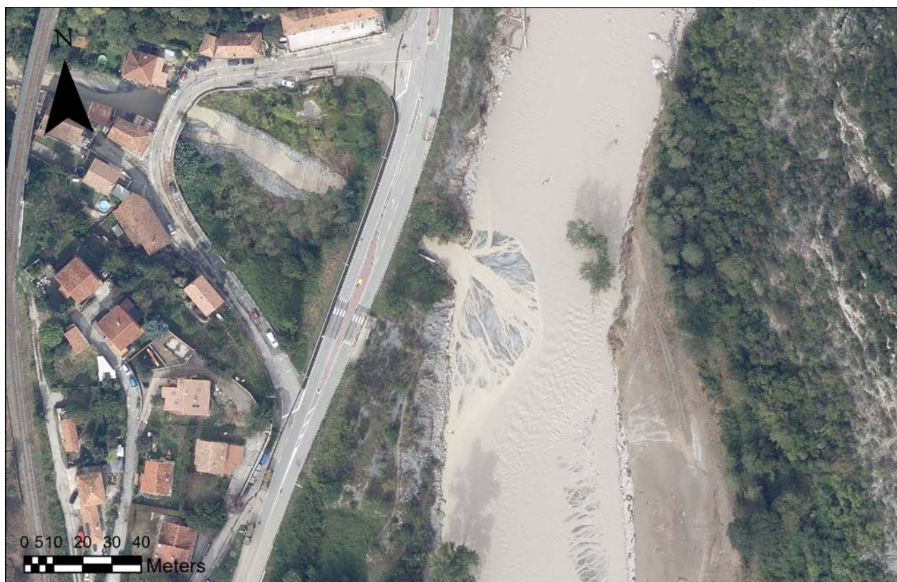
Figure 4. Nouveau cône alluvial généré par la crue à la confluence de la Roya et du vallon de la Maglia
