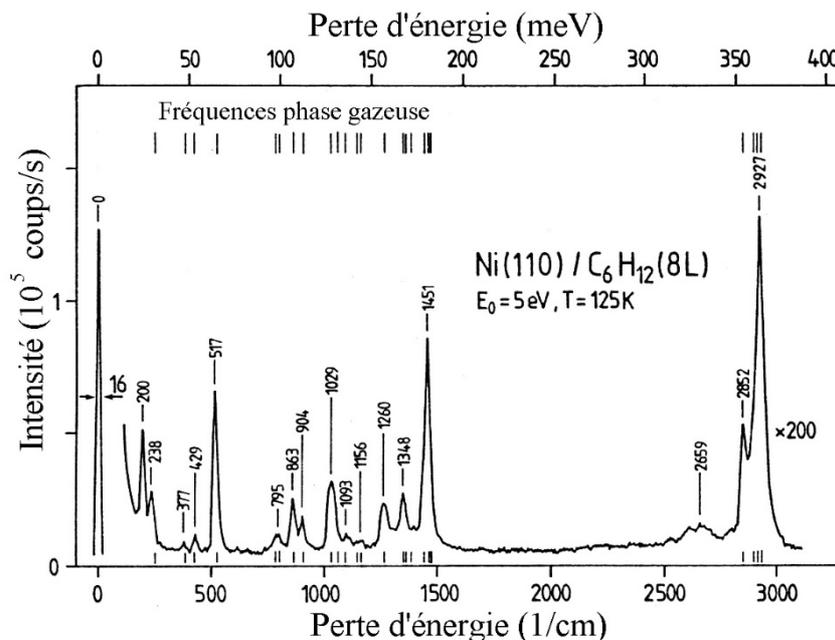
Spectre HREELS surface Ni(110) exposée à 8 L de C<sub>6</sub>H<sub>12</sub>. E<sub>i</sub> = 5 eV, Largeur à mi-hauteur (FWHM) 2 meV (16 cm<sup>-1</sup>) - 1 meV  $\equiv$  8,065 cm<sup>-1</sup>. **Adsorption à plat non dissociative** - H. Ibach *et al.* *Surf. Sci.* **269/270** (1992) 94.
