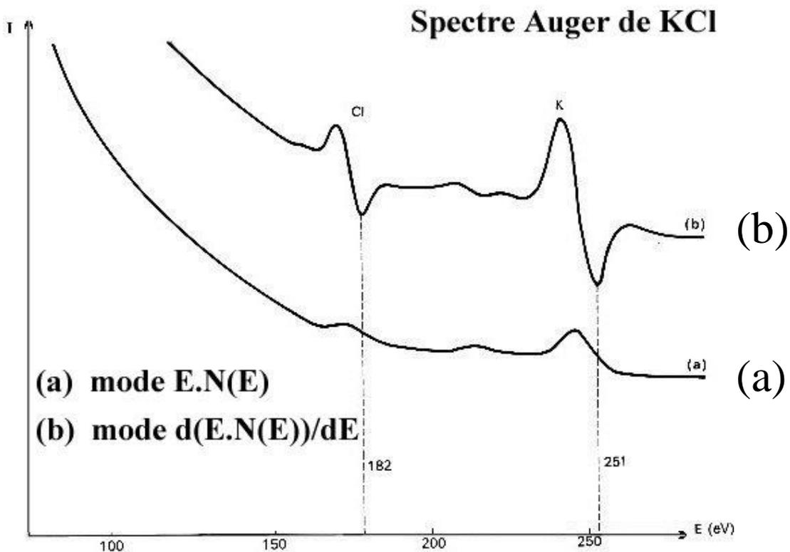
$K^{19}$  électron Auger LMM 251 eV,  $Cl^{17}$  électron Auger LVV 182 eV.
