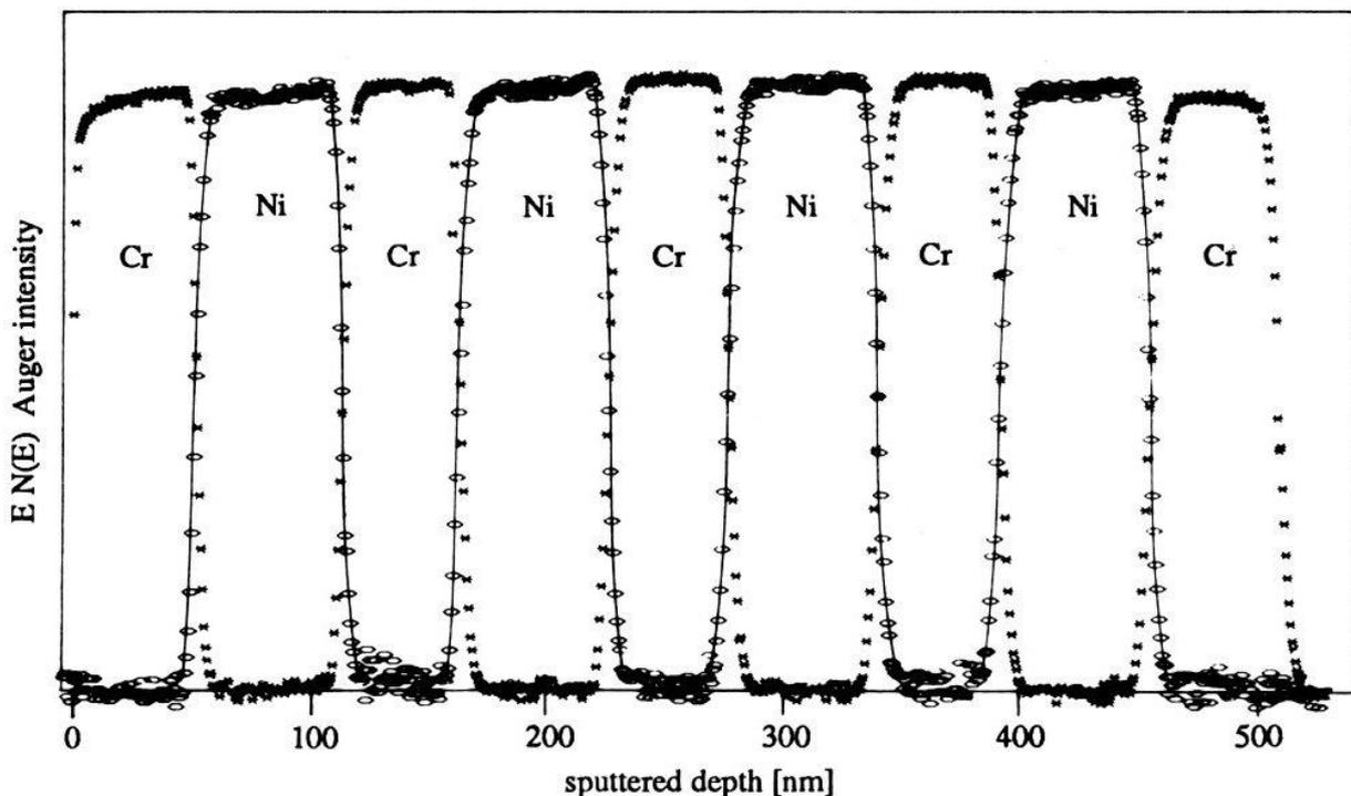
Profil Auger d'un échantillon multicouche NiCr (abrasion 1 keV Ar<sup>+</sup>) Fine et Navinsek *J. Vac. Sci. Technol.* A3 (1985) 1408.
