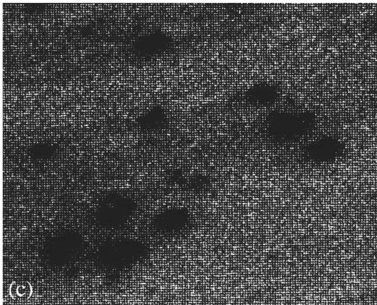
Particules d'or sur substrat de silicium Au / Si - (b) Image d'émission Auger de Au, (c) Image d'émission Auger de Si. Document RIBER Lab. de cristallographie IPCMS ULP Strasbourg.
