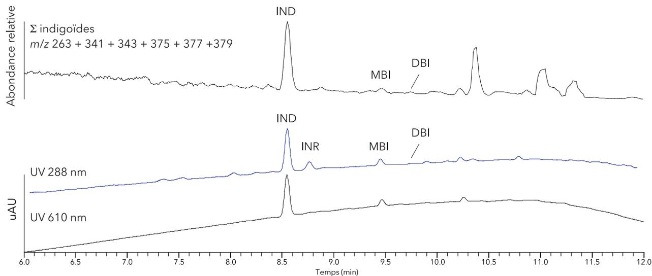
Fig. 4. Chromatogramme uHPLC/UV-ESI-MS de l'extrait DMSO obtenu à partir de la jarre K18-516. Le signal en ESI+ révèle les ions typiques de l'indigotine IND et de l'indirubine IDR ( $m/z$  263), de la 6-monobromindigotine MBI ( $m/z$  341 + 343), et de la 6,6'-dibromindigotine DBI ( $m/z$  375 + 377 + 379). Les indigoïdes sont aussi détectés par absorption UV à 288 nm et 610 nm (© N. Garnier).
