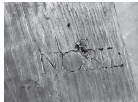
Fig. 188a et 188b : Vue de deux des trois inscriptions de la marque NOBIL•M[---?] frappée sur la face inférieure de la vaigre Va37 (S. Marlier).
