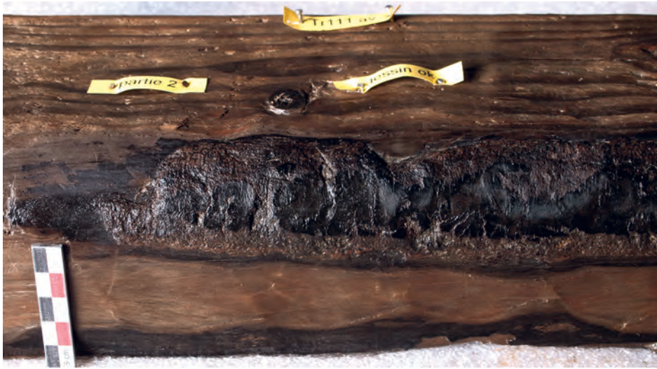
Fig. 259: Chanfrein de la traverse Tr111 formé de la périphérie non écorcée de la grume d'origine (T. Seguin, O'Can-Ipsos Facto, MdAa/CG13).
