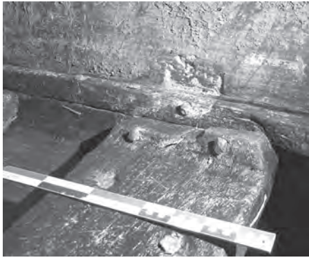
Fig. 102 : Vue, dans la partie centrale de la coque, de l'assemblage du tasseau au bouchain et au flanc par des clous et de l'empreinte laissée par la traverse sur sa face supérieure (L. Roux, O'Can-Ipsa Facto , MdAa/CG13).
