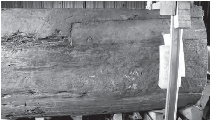
Fig. 164: Planche de réparation clouée sur la face externe du bordé de flanc F11, au niveau de la maille M121-M123 (L. Roux, O'Can-Ipsa Facto, MdAa/CG13).
