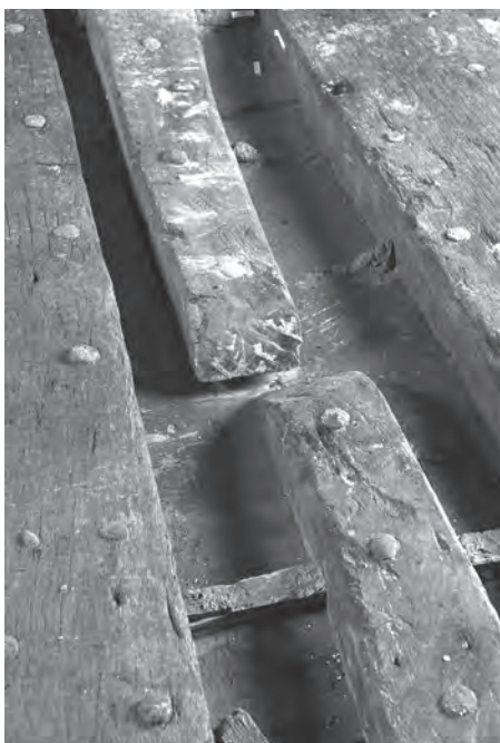
Fig. 73: Courbes C13 et C14, disposées en vis-à-vis en avant de l'emplature de mât, et dont les bras horizontaux se rejoignent au niveau de l'axe du bateau (L. Roux, O'Can-Ipso Facto, MdAa/CG13).
