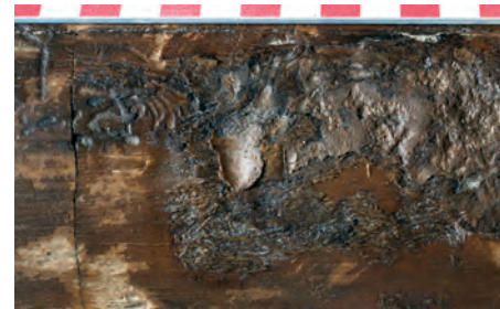
Fig. 245 : Écorce résiduelle et galeries de scolythes (à gauche) visibles sur la surface du mât de halage (L. Roux, O'Can-Ipso Facto, MdAa/CG13).
