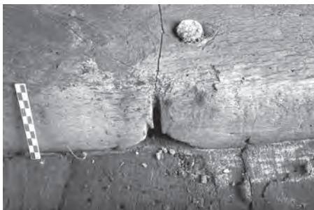
Fig. 71: Canal de forme triangulaire sur la face avant de la varangue-emplature (L. Roux, O'Can-Ipso Facto, MdAa/CG13).
