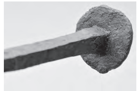
Fig. 143 : Clou d'assemblage de la varangue M105 à la sole présentant une surface plate du métal sous la tête (L. Damelet, CCJ/CNRS).
