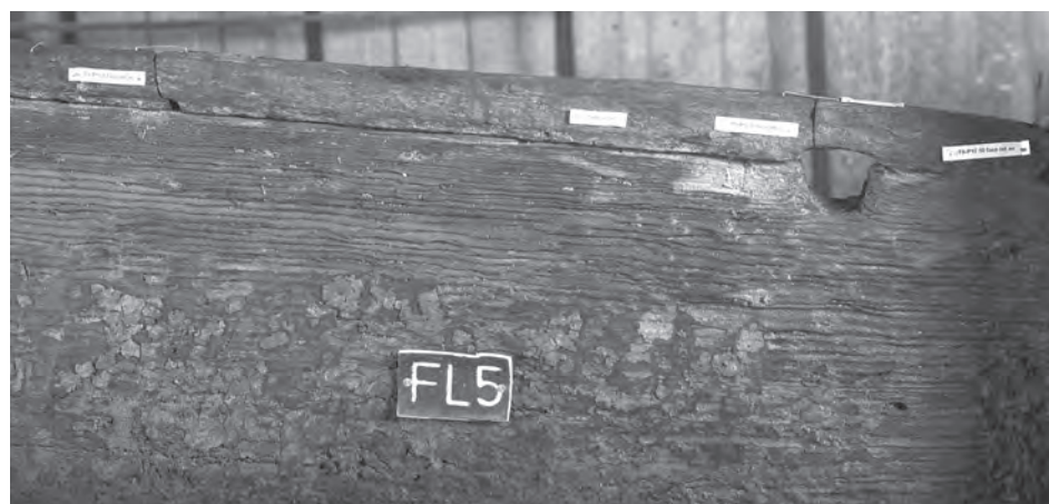
Fig. 91 : Intérieur, sur bâbord avant, de la planche de plat-bord P17, disposée sur le haut du bordage de flanc F15 avec un orifice percé à l'intersection des deux pièces (L. Roux, O'Can-Ipso Facto, MdAa/CG13).
