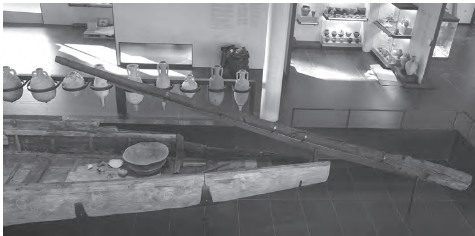
Fig. 269 : La pelle de gouverne remise en place sur le chaland Arles-Rhône 3 au sein du Musée départemental Arles antique (ARC-Nucléart).
