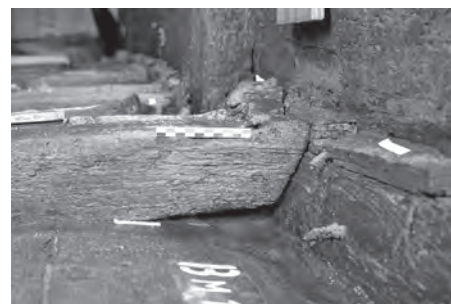
Fig. 43 : Décollement de l'extrémité de la membrure M106, au niveau du bouchain bâbord, à mettre en relation avec le naufrage (T. Seguin, O'Can-Ipso Facto, MdAa/CG13).
