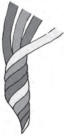
Fig. 277: Cordage, échantillon objet 2 (2007). Représentation schématique des éléments qui composent le toron (F. Médard, Anatex).
