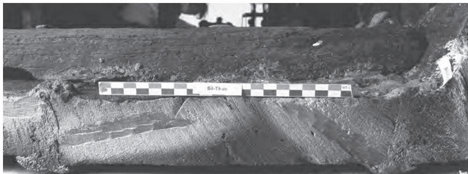
Fig. 30 : Section avant du bordage B8 du tronçon T9 préparée pour l'enregistrement de deux chemins de mesure (L. Roux, O'Can-Ipso Facto, MdAa/CG13).
