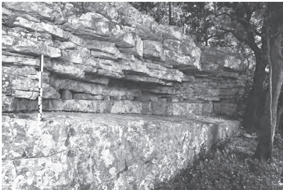
Fig. 328 : Épaisseurs des bancs de calcaire de la carrière de Saint-Gabriel. En partie haute les bancs les plus fins (la découverte) et au dessous les bancs plus épais (R. Bénali/Studio Atlantis, MdAa/CG13).
