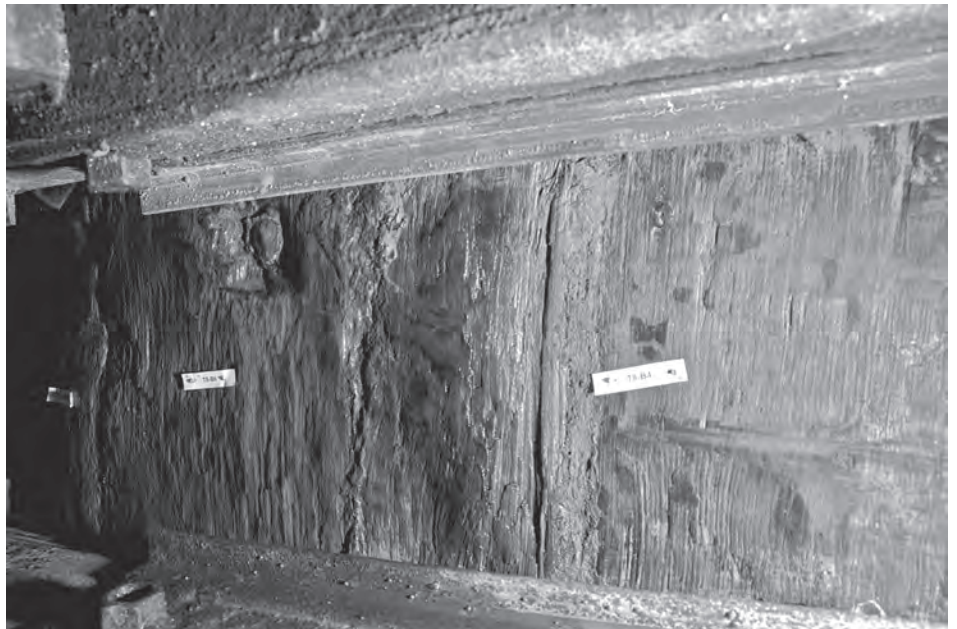
Fig. 145 : Vue, sur l'extérieur de la sole, d'un évidement creusé dans le bois du bordage pour recevoir la tête de clou ainsi que d'une fissure longitudinale sous le bordage B4 (L. Roux, O'Can-Ipso Facto, MdAa/CG13).
