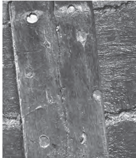
Fig. 85 : Têtes de clous enfoncés depuis le dos d'une varangue pour sa fixation à la sole. Et pointes de clous rabattues sur le dos de la varangue correspondant aux clous enfoncés depuis l'extérieur de la sole (L. Roux, O'Can-Ipso Facto, MdAa/CG13).
