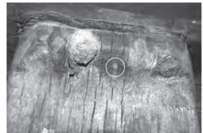
Fig. 263 : Vue de la localisation d'un petit clou (auquel il manque la tête) planté dans le ressaut d'une extrémité de varangue (S. Marlier).
