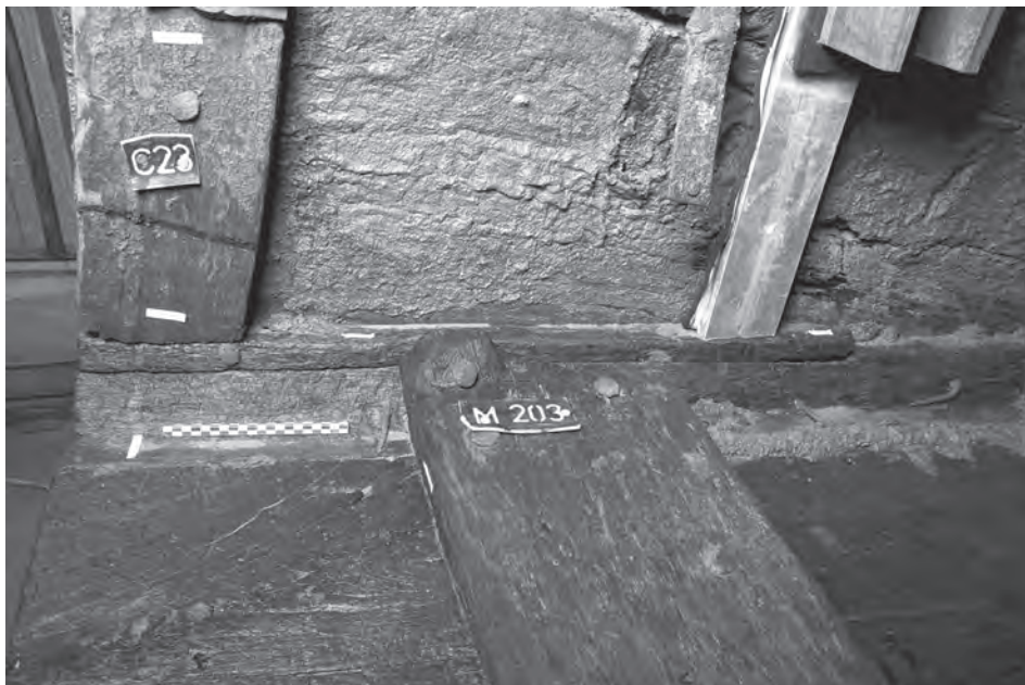
Fig. 100 : Vue, sur bâbord, au niveau de la membrure M133 (M203 en n° subaquatique) de l'extrémité avant du tasseau Ta3 qui vient buter contre un décroché aménagé dans la face supérieure du bordé monoxyde de transition BM3 (L. Roux, O'Can-Ipso Facto, MdAa/CG13).
