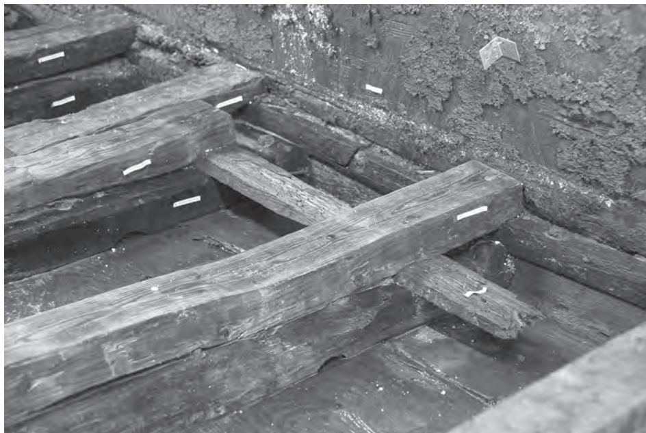
Fig. 175 : Vue du longeron L13 disposé entre la varangue M121 et la traverse Tr121 dont l'extrémité repose sur le tasseau (L. Roux, O'Can-Ipso Facto, MdAa/CG13).
