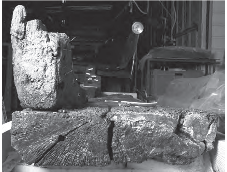
Fig. 243 : Banc d'étambrai débité dans un demi-tronc de chêne vu dans sa section transversale bâbord (L. Roux, O'Can-Ipsa Facto, MdAa/CG13).
