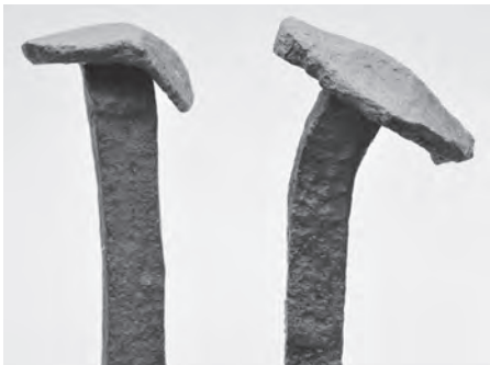
Fig. 150 : Têtes de clous, utilisés pour la liaison des flancs aux bouchains, ployées par les coups de marteau (L. Damelet, CCJ/CNRS).
