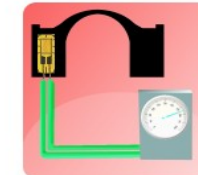
Pégase-Pont de jauges Mesure de la micro-déformation des structures
