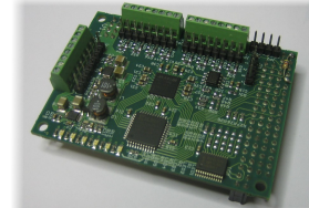
Analogique générique : 8 voies / 16 bits / 50 kHz
