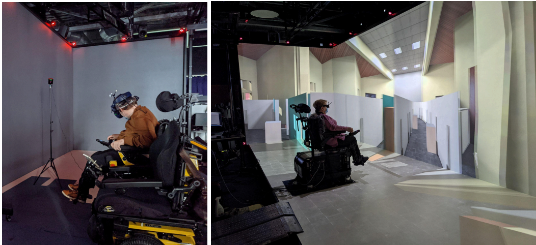
Figure 2 : Simulateur de conduite de FRE en réalité virtuelle : casque et salle immersive (étude clinique SIMADAPT2)
