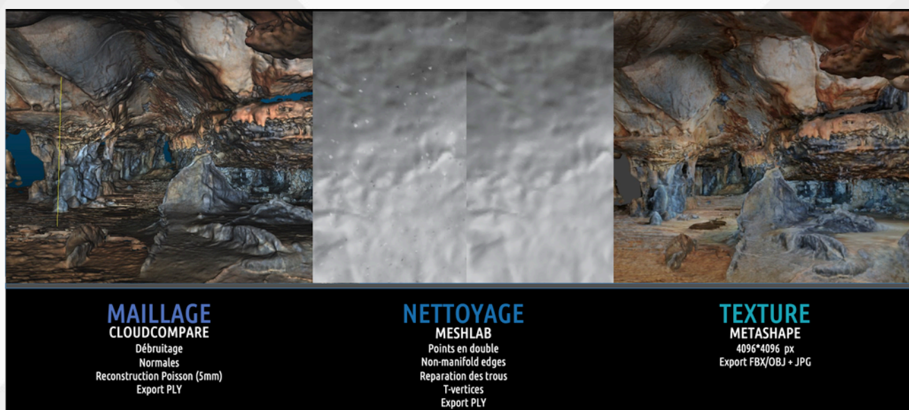
Fig. 2 - Processus de reconstruction à partir des nuages lasergrammétriques
