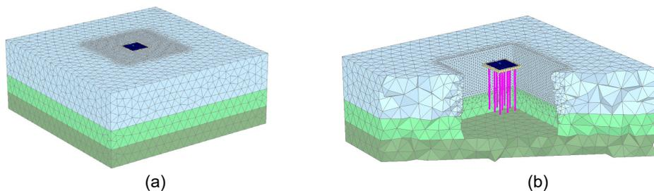
Figure 3 : Modèle EF d'une semelle sur inclusions rigides
