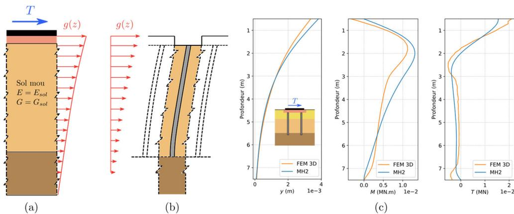
Figure 8 : Approche analytique MH2 – (a) étape 1 et (b) étape 2 et (c) comparaison avec l'approche FEM 3D
