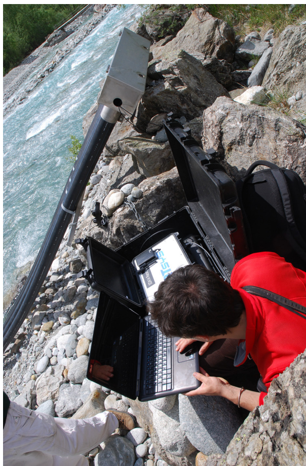
Station métrologique hydrophonique du Plan du lac
