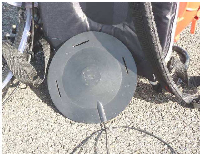
Figure 2 : Mesure des vibrations : fixation de l'accéléromètre au niveau du dos de l'opérateur
