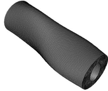
Figure 6 : Vue du maillage sur une période de déformation extérieure
