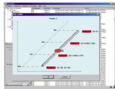
En cas de ruptures présumées, il informe les gestionnaires de l'ouvrage en envoyant des alarmes sous forme de SMS. En absence d'alarmes, la consultation de l'état de santé de l'ouvrage est possible via un portail internet dédié à ce dernier ce qui permet une gestion souple du système.
