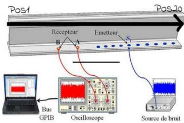
Fig1: Dispositif expérimental [3]
