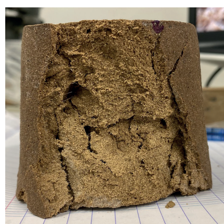
Éprouvette de 8% de biopolymère avant et après l'essai
