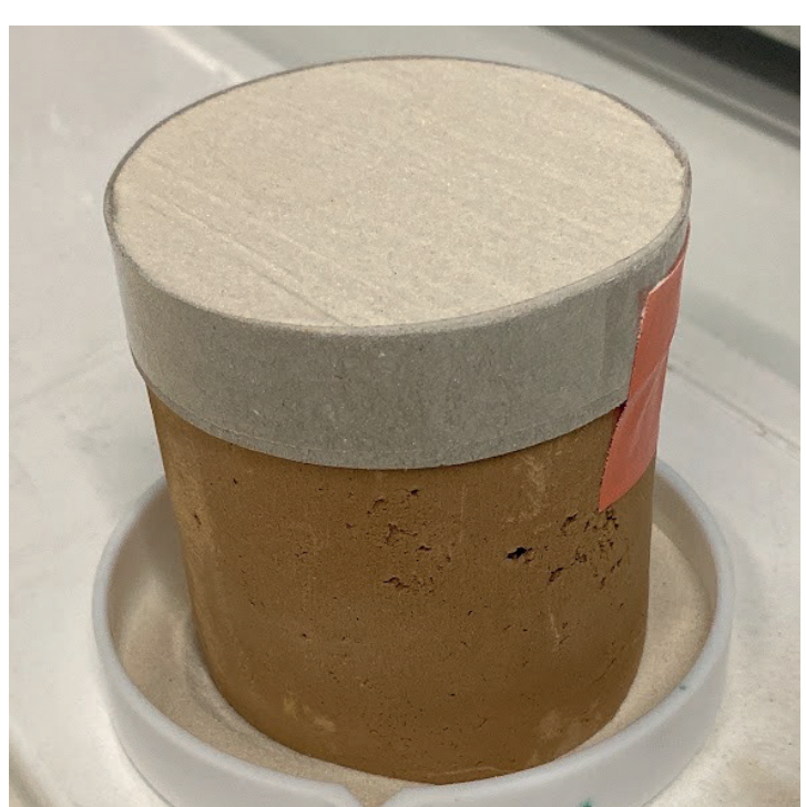
Éprouvette de 8% de biopolymère avant et après l'essai
