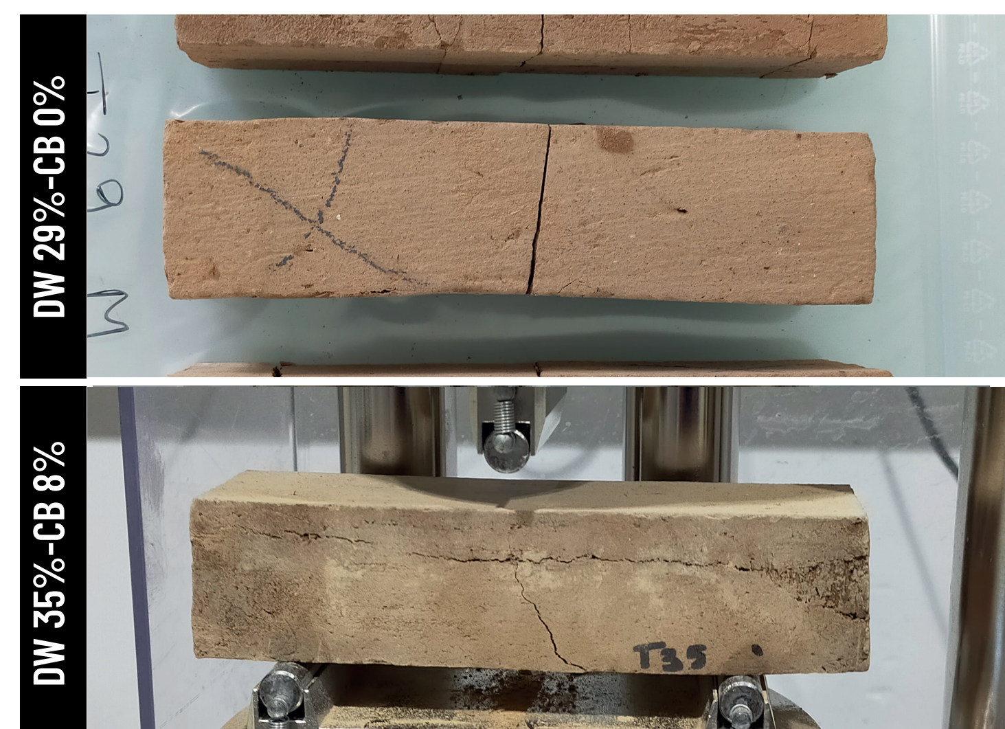
Rupture pour spécimens de 0% et 8% de biopolymère
