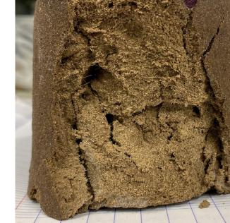
Éprouvette de 8% de biopolymère avant et après l'essai
