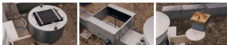
Figure 0-6 : Détecteurs de précipitations : de gauche à droite le modèle Précis Mécanique®, et les modèles Eigenbrodt® IRSS88, et RS85
