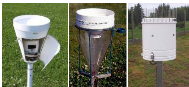
Figure 0-5 : Pluviomètres des observatoires BAPMoN (gauche), CATAENAT (centre) et MERA (droite)
