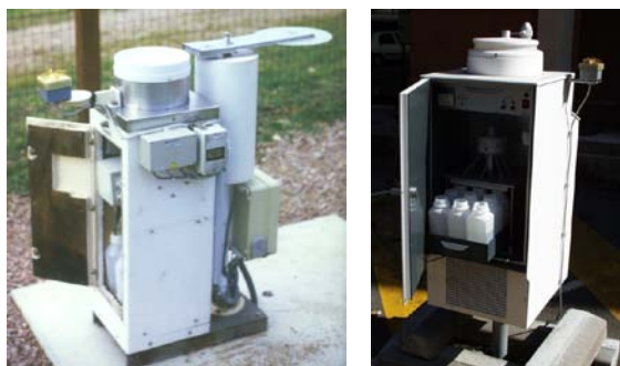
Figure 0-2 : Observatoire MERA : les collecteurs de retombées humides Précis Mécanique®/Icare® (gauche) et Eigenbrodt® NSA 181/KHS (droite)
