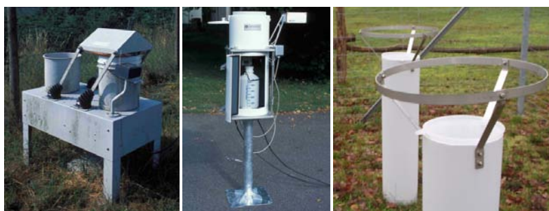
Figure 0-4 : Observatoire CATAENAT : les collecteurs de retombées humides Andersen® APS (gauche) et Eigenbrodt® UNS 130/S (milieu) et les collecteurs de retombées totales par jauge d'Owen (droite)
