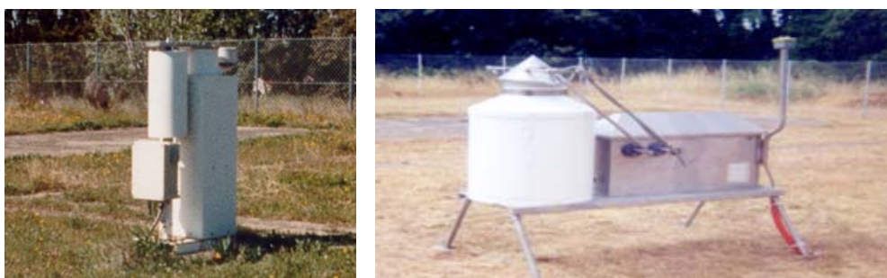
Figure 0-3 : Observatoire BAPMoN : les collecteurs de retombées humides Précis Mécanique® (gauche) et Météo France® (droite)
