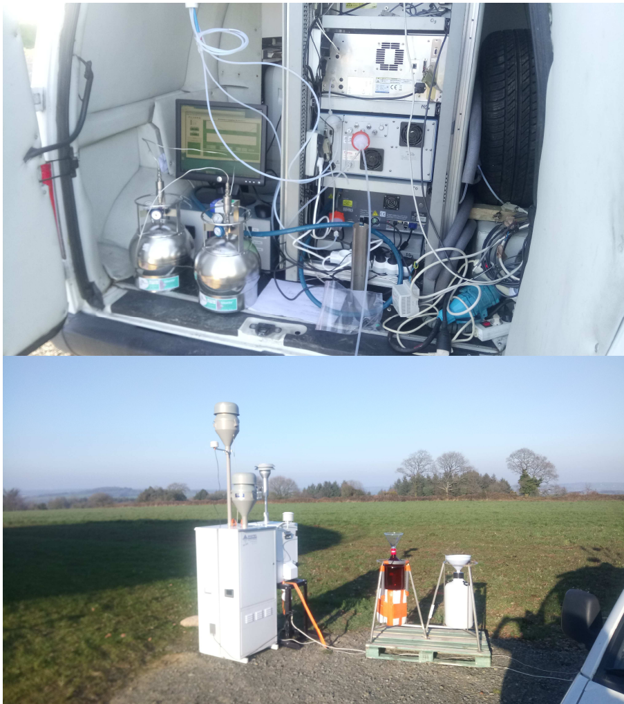
Figure 3: Photographies des instruments de mesure dans le camion laboratoire et des préleveurs extérieurs
