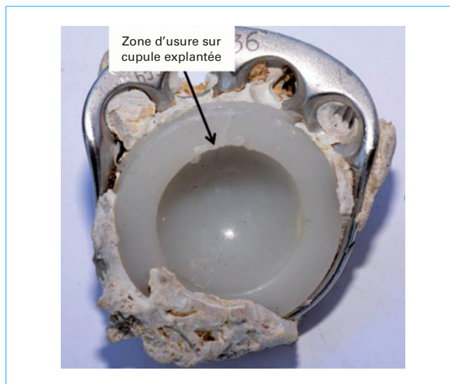
Figure 6 - Prothèse de hanche : traces d'usure sur l'insert en polyéthylène
