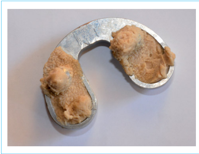
Figure 8 – Exemple d'usure de l'insert en polyéthylène d'une prothèse de genou
