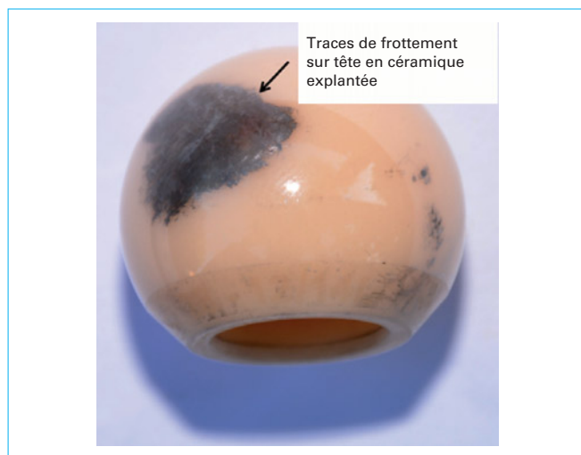
Figure 7 – Prothèses de hanche : traces de frottement sur la tête fémorale
