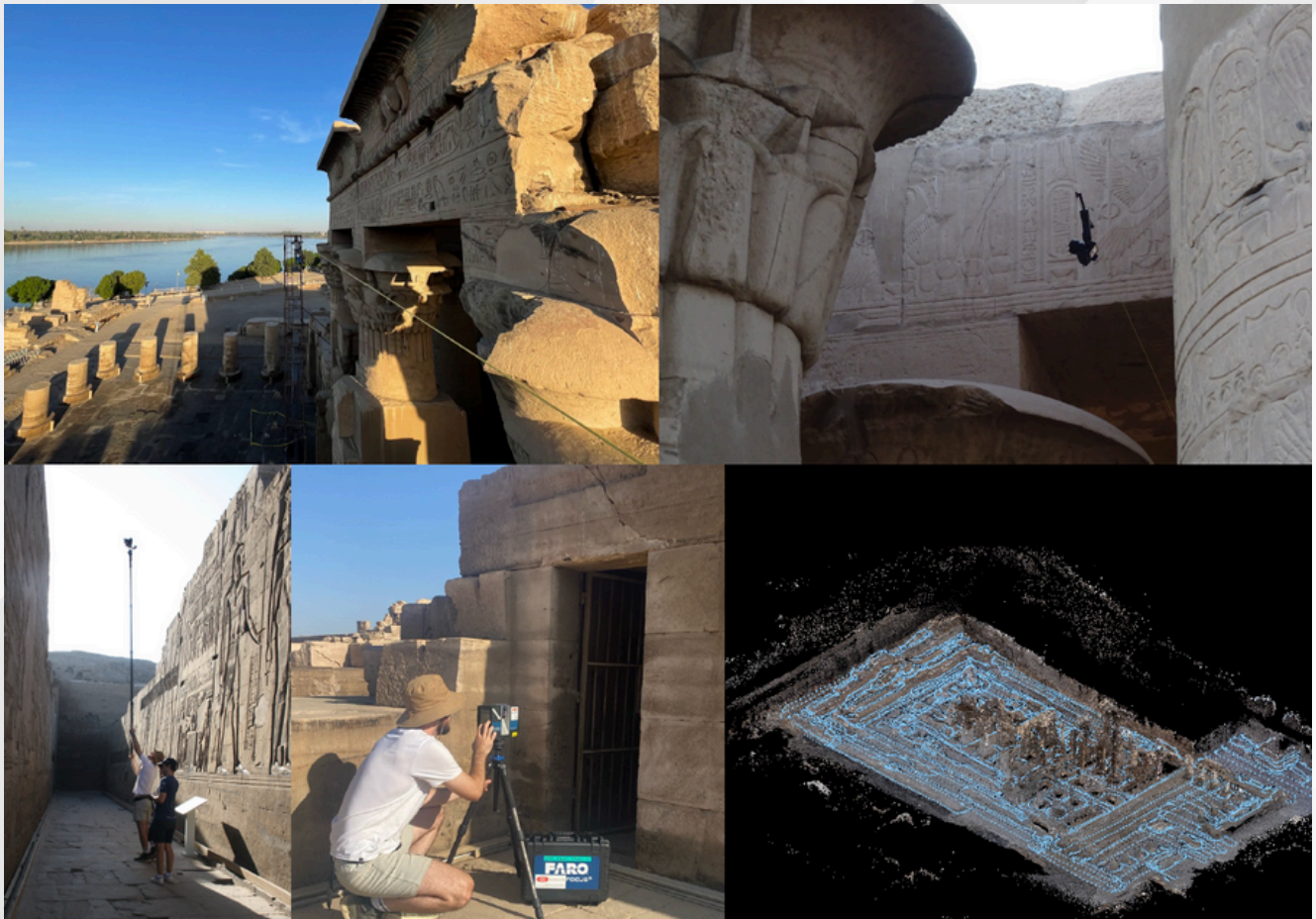
Fig. 3 : Relevé photographique avec tyrolienne et perche, laser scanner et étape d'alignement des clichés sur Metashape (©Uzufly et A. Terrier )
