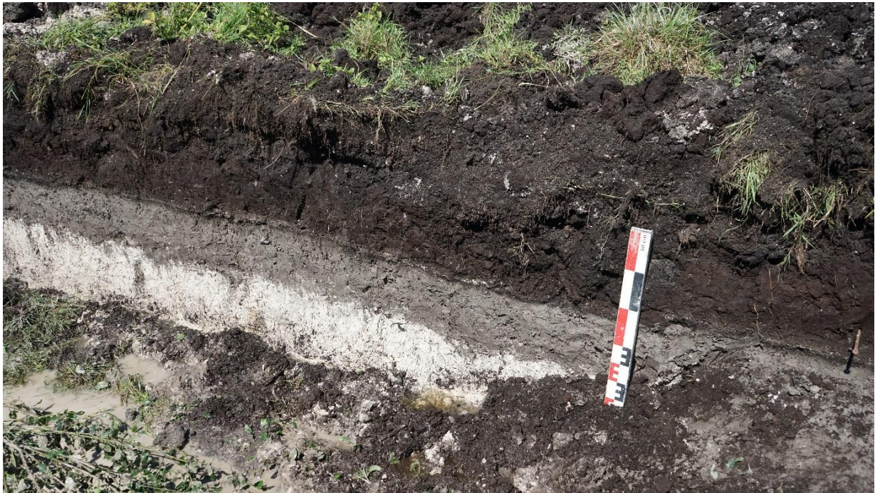
Figure 7 : Sondage profond à l'extrémité sud-ouest de la tranchée 1. On observe à la base de la séquence de la craie lacustre blanche surmontée par une couche de limons argileux grise. Au sommet de cette dernière on distingue de fins niveaux noirs et blancs recouverts par environ 40 cm de tourbe (cliché N. Bernigaud 2018).
