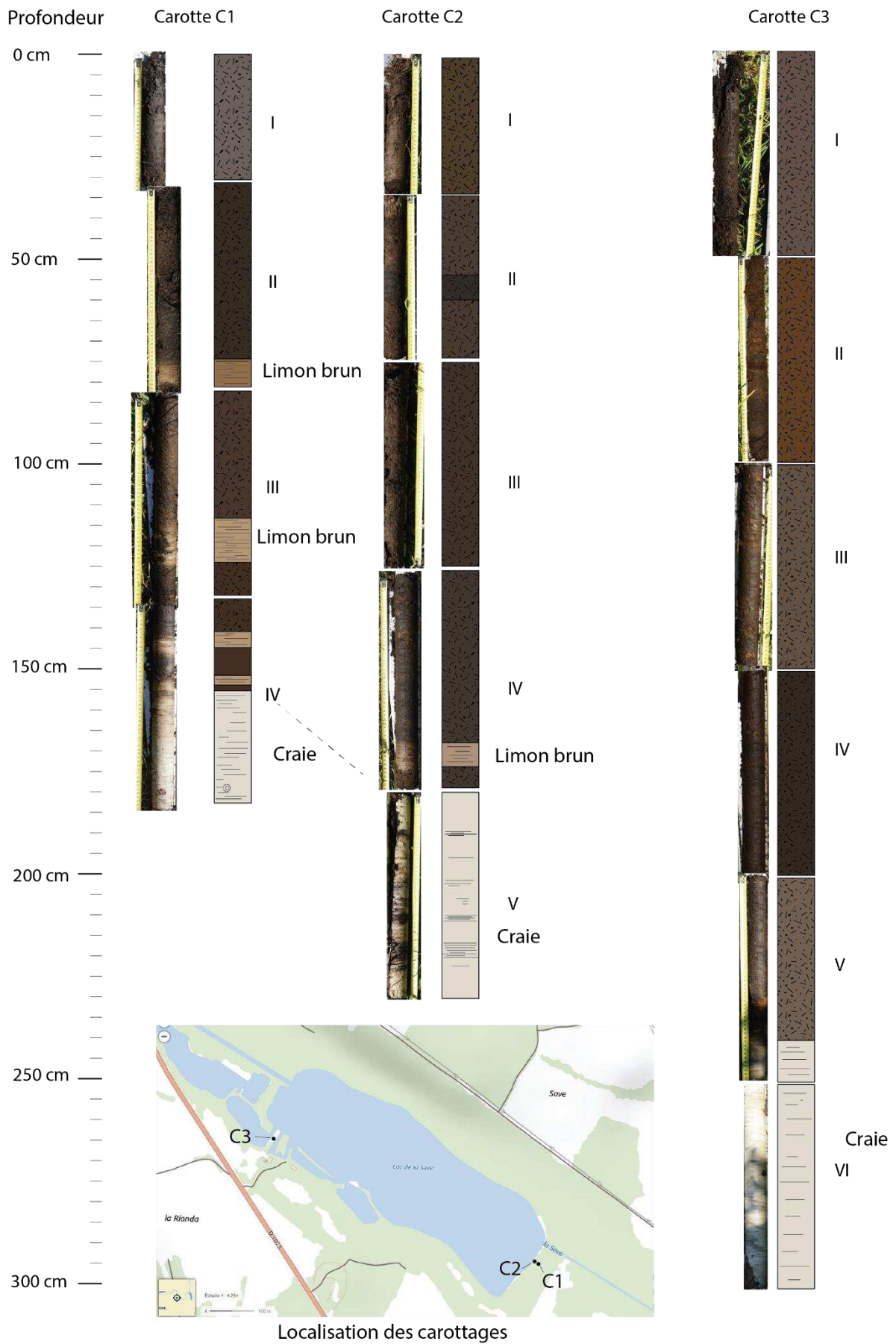
Figure 21 : Dessin des 3 carottes de tourbe et de craie prélevées sur les rives du lac de Save (DAO N. Bernigaud).
