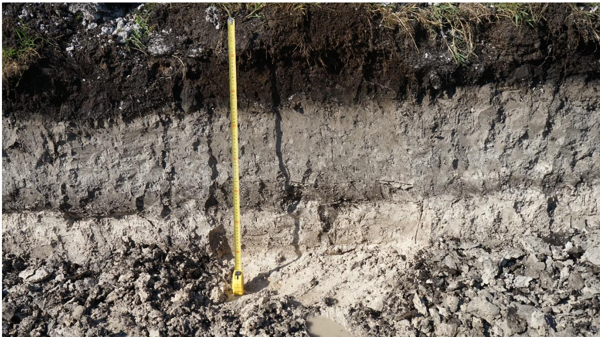
Figure 15: Détail de la stratigraphie dans la partie septentrionale de la branche sud-est. On voit ici entre la craie blanche à la base de la stratigraphie et la couche de limons argileux gris un niveau noir qui n'apparaît pas ailleurs. Au sommet se trouve une couche de tourbe noire minéralisée d'environ 25 cm d'épaisseur (cliché N. Bernigaud 2018).
