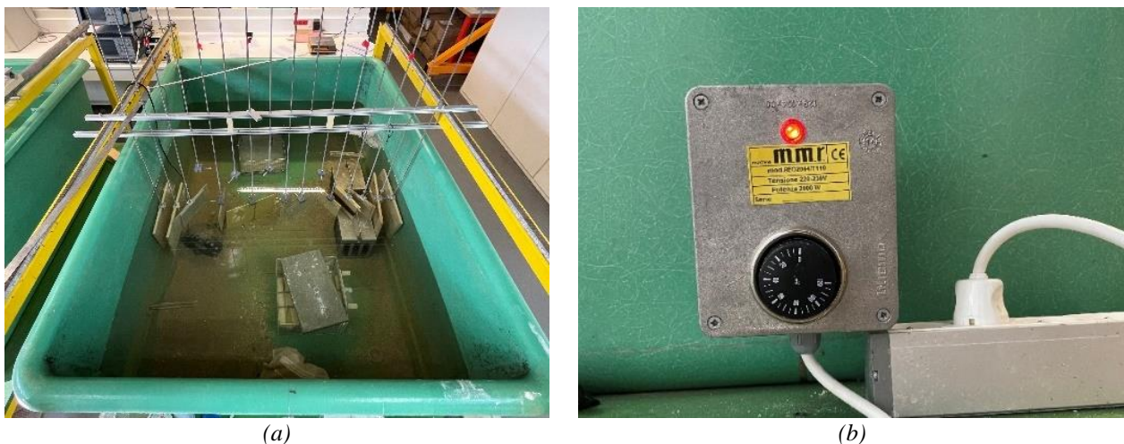
Fig. 1. (a) Cuve d'immersion et (b) thermostat de régulation pour le vieillissement accéléré des échantillons.
