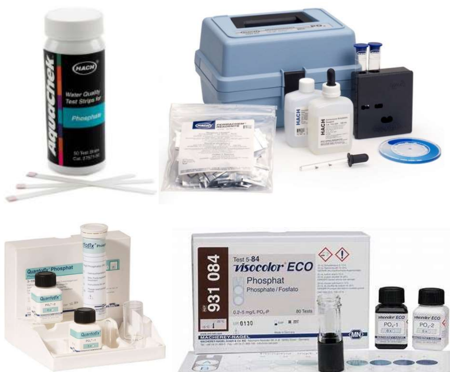
Figure 22 : Exemples de tests colorimétriques ou bandelettes pour le suivi de la concentration de phosphates
