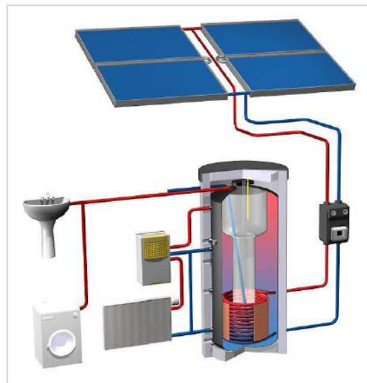
Figure 8. Schéma de principe système solaire combiné (Source « Cartographie de la filière Solaire »)
