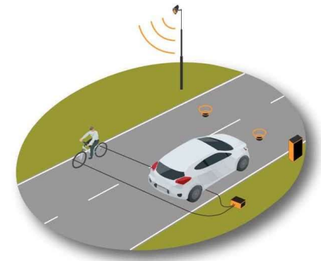
Comptage par tube pneumatique Comptage par capteur magnétique Comptage par caméra
