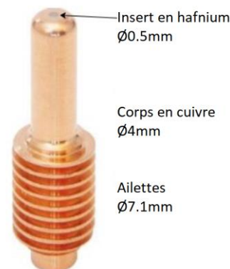
FIG. 1. Electrode cotée
