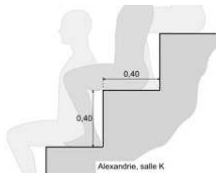
Profil des gradins de la salle F d'Alexandrie, avec disposition alternée des auditeurs
